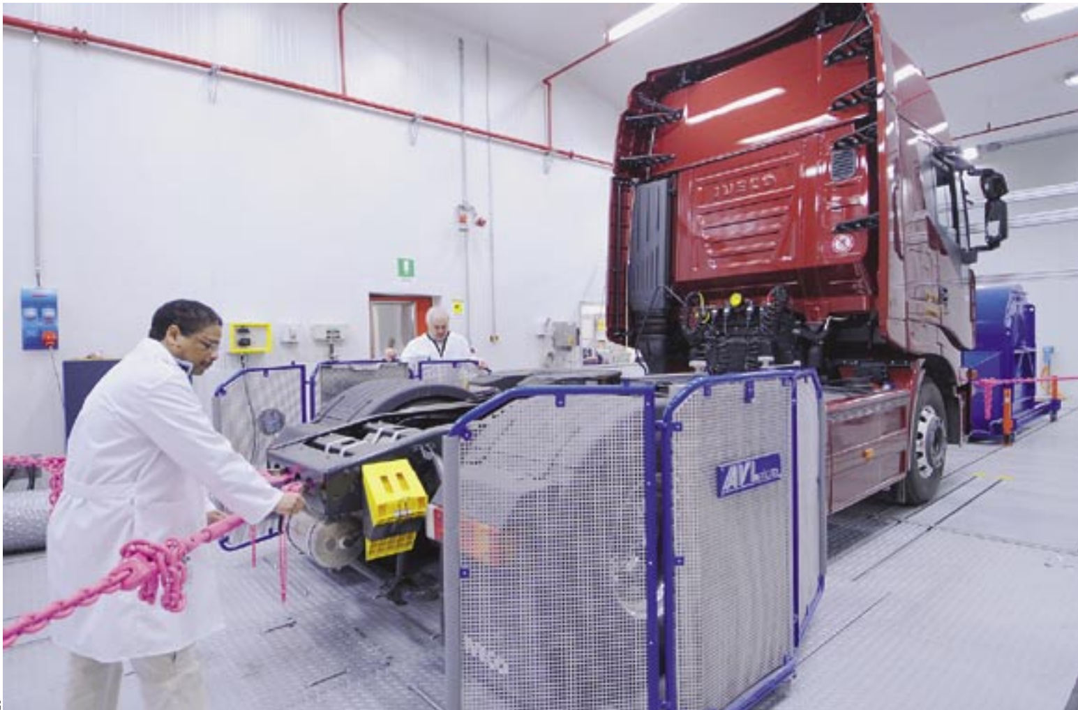
Le tout nouveau laboratoire Vela 7 d'Ispra doit mesurer précisément l'impact que le trafic routier peut avoir sur l'environnement. Il s'intéressera bien sûr aux véhicules existants, mais aussi à ceux de nouvelle génération. Il peut accueillir des camionnettes, des semi-remorques ou des autobus mesurant jusqu'à de 12 m de long et pesant 40 tonnes.
